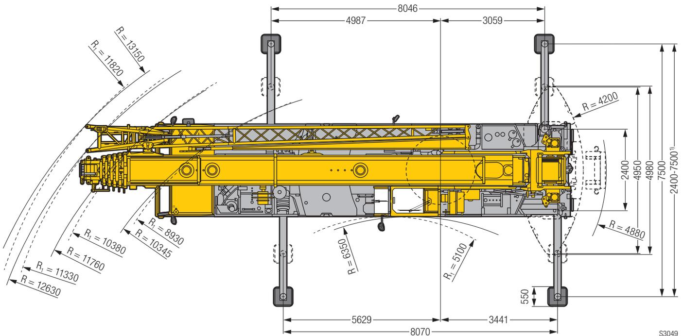
R<sub>1</sub> = Allradlenkung · All-wheel steering · Direction toutes roues · Tutti gli assi sterzanti · Dirección en todos los ejes · Поворот всеми колесами
